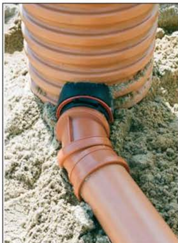
AC 2001 110/138 med afvinkling 0-90°. Afhjælper spændinger i samlingen.
